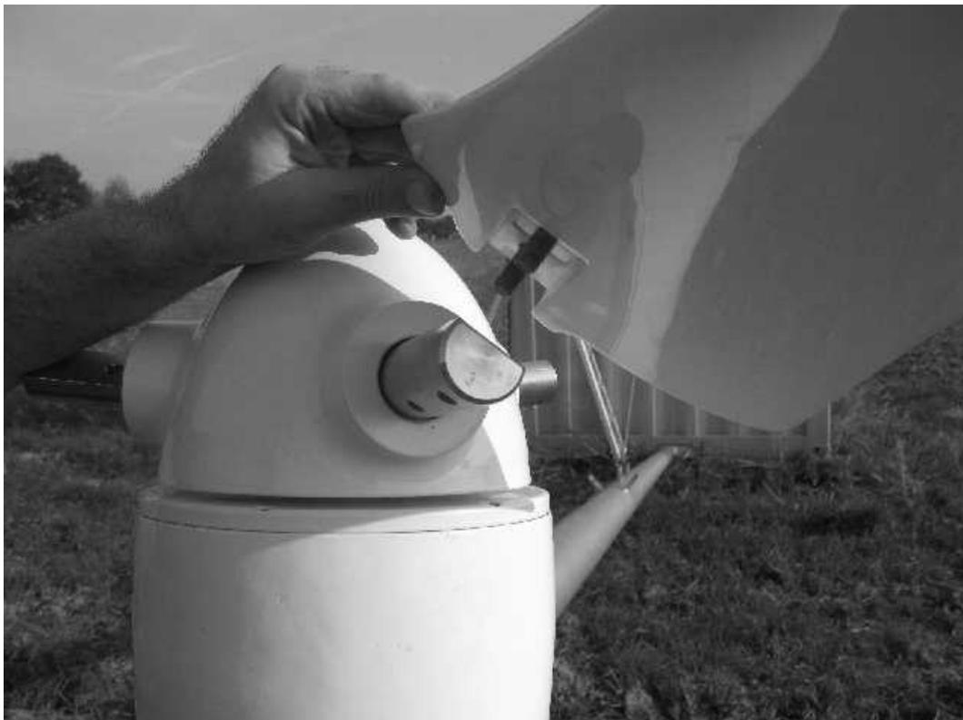
Schrauben Sie beide Schrauben einige Millimeter in die Gewinde der Achse ein. Schieben Sie nun das Rotorblatt soweit bis auf die Achse, daß die beiden Flächen (Vertiefung und Abflachung) sauber aufeinander liegen.
