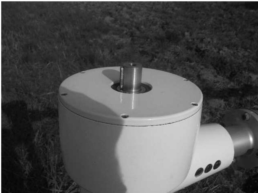
Richten Sie die Nabe gerade zur Generatorwelle aus und schieben Sie sie vorsichtig bis zum Anschlag.
