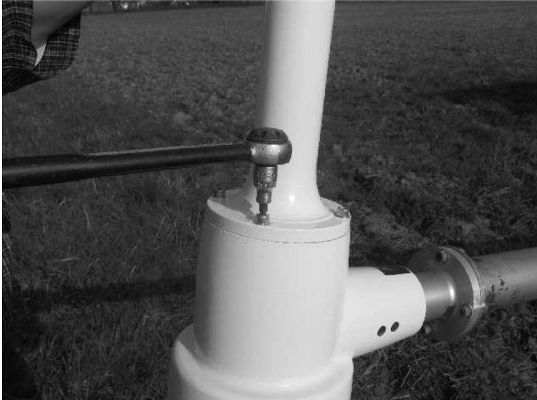
Setzen Sie die vier Schrauben M8 x 50 mit den Unterlegscheiben 8,5 in die Löcher des Flansches ein. Achten Sie während des Einschraubens darauf, daß der O-Ring korrekt in die Gondel einfädelt. Dazu ist es ratsam, die Schrauben abwechselnd jeweils um eine halbe Umdrehung einzuschrauben. Ziehen Sie die Schrauben abschließend mit 25 Nm fest.
