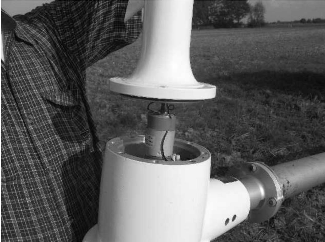
Setzen Sie den Flansch des Flossenauslegers auf die Rückseite der Gondel und richten Sie die vier Bohrungen aus. Die Windfahne muß, nachdem die Maschine aufgerichtet wurde, nach oben zeigen.
